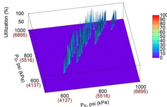
图 2 - 流量为 300 mmcf (8.50 Mm<sup>3</sup>/d) 时，随吸入压力 (P<sub>s</sub>) 和排出压力 (P<sub>d</sub>) 变化的利用率百分比
