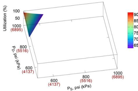
图 17 - 在流量为 150 mmcf/d (4.25 Mm³/d) 时, 随吸入压力 (PS) 和排出压力 (PD) 变化的离心式压缩机利用率百分比; 最小功率设置为最大功率的 60%
