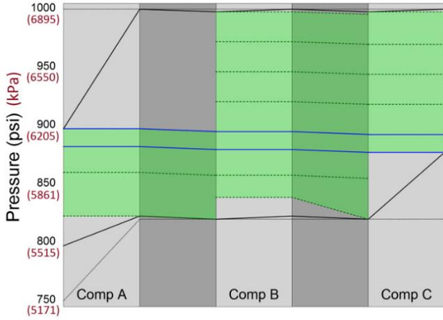
图 34 - 管道流量为 50 mmcfd (1.42 Mm<sup>3</sup>/d) 时的可行性图。唯一可行的运行模式是完全旁路所有压缩机。
