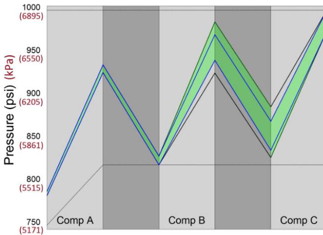
图 13 - 335 mmcf/d (9.49 Mm<sup>3</sup>/d) 管道流量时的可行性图。所有三个压缩机都在压缩
