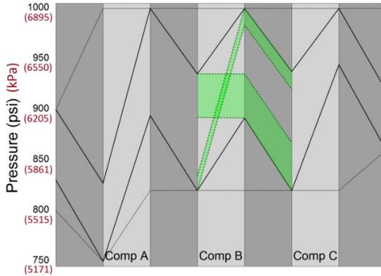
图 30 - 流量为 275 mmcf (7.79 Mm<sup>3</sup>/d) 时，压缩机 B 可行性表的图示；压缩机 B 排放口对应的可行区域，通过下游管道延伸至压缩机 C 的吸入口
