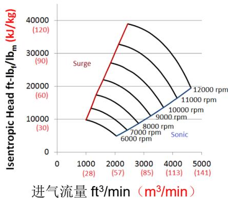
图 13 - 压缩机 CC 的扬程流量图
