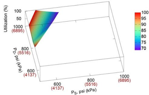
图 16 - 在流量为 200 mmcf/d (5.66 Mm³/d) 时, 随吸入压力 (PS) 和排出压力 (PD) 变化的离心式压缩机利用率百分比; 最小功率设置为最大功率的 60%
