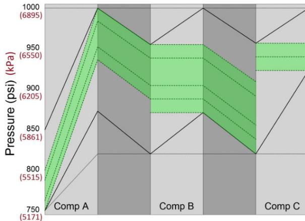
图 10 - 230 mmcf/d (6.51 Mm<sup>3</sup>/d) 管道流量时的可行性图。管道运行是不可行的，因为压缩机 B 的旁路状态与压缩机 C 的旁路状态不相交
