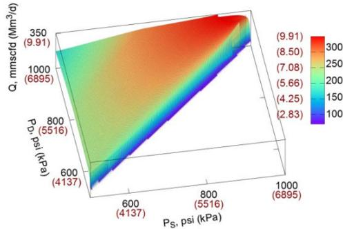
图 3 – 未设置最小功率、不允许音速运行的离心式压缩机排气量 (Q)
