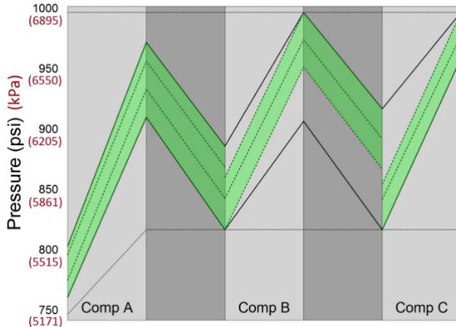
图 12 - 310 mmcf/d (8.79 Mm<sup>3</sup>/d) 管道流量时的可行性图。管道运行是不可行的，因为气体以过高的压力进入压缩机 C
