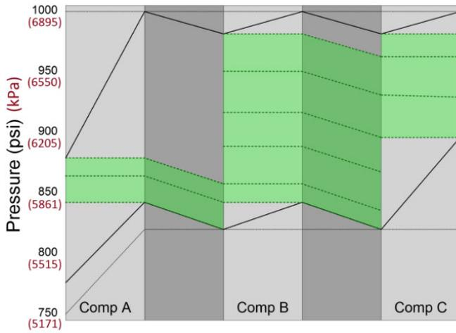
图 8 - 150 mmcfd (4.25Mm<sup>3</sup>/d) 管道流量时的可行性图。管道无法运行，因为整个管道的可行区域之间没有连接。管道的摩擦压力损失太大，无法满足最小输送压力，并且由于最小功率要求，压缩是不可能的。
