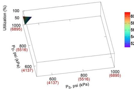
图 18 - 在流量为 100 mmcf/d (2.83 Mm³/d) 时, 随吸入压力 (PS) 和排出压力 (PD) 变化的离心式压缩机利用率百分比
