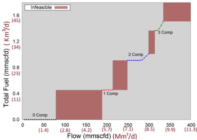
图 33 - 流量从 0 变化到 400 时的管道燃料用量。红色区域表示没有潜在管道运行可行性的流量
