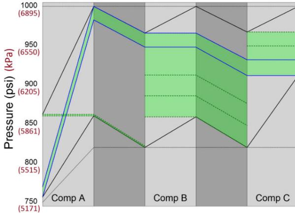
图 9 - 200 mmcf/d (5.66 Mm<sup>3</sup>/d) 管道流量时的可行性图。压缩机 A 正在压缩，而压缩机 B 和 C 被旁路
