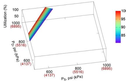
图 10 - 流量为 150 mmcf/d (4.25 Mm<sup>3</sup>/d) 时，随吸入压力 (PS) 和排出压力 (PD) 变化的压缩机 RC\_fixed\_s\_var\_cl\_min\_power 利用率百分比；计算是在 500psig (3447kPa) 至 1000psig (6895kPa) 的压力范围进行的
