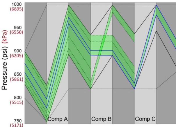
图 11 - 275 mmcf/d (7.79 Mm<sup>3</sup>/d) 管道流量时的可行性图。可行运行包括旁路压缩机 B 并通过压缩机 A 和 C 进行压缩
