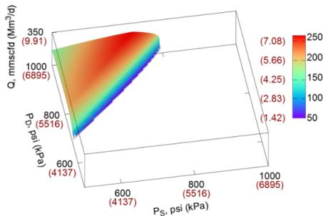
图 15 - 随吸入压力 (PS) 和排出压力 (PD) 变化的离心式压缩机排气量；最小功率设置为最大功率的 60%
