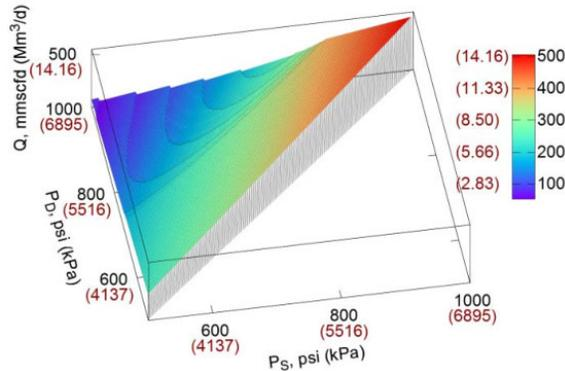
图 1 – 随吸入压力 (P<sub>s</sub>) 和排出压力 (P<sub>d</sub>) 变化的压缩机 RC\_fixed\_s\_fixed\_cl 排气量 (Q)
