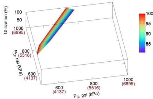
图 9 - 流量为 200 mmcf/d (5.66 Mm<sup>3</sup>/d) 时，随吸入压力 (PS) 和排出压力 (PD) 变化的压缩机 RC\_fixed\_s\_var\_cl\_min\_power 利用率百分比
