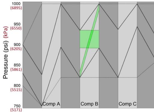
图 7 - 流量为 275 mmcf/d (7.79 Mm<sup>3</sup>/d) 时，压缩机 B 可行性表的图示；水平绿色框表示可行的压缩机旁路状态，而倾斜的绿色部分表示可行的压缩状态
