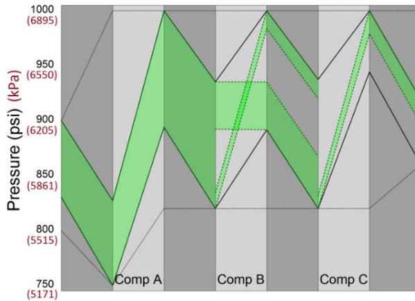
图 31 - 275 mmcf (7.79 Mm<sup>3</sup>/d) 流量下，所有压缩机可行性表的图示
