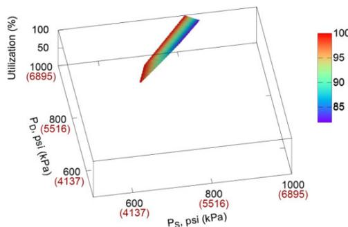
图 7 - 流量为 300 mmcf (8.50 Mm³/d) 时，随吸入压力 (PS) 和排出压力 (PD) 变化的压缩机 RC\_fixed\_s\_var\_cl\_min\_power 利用率百分比
