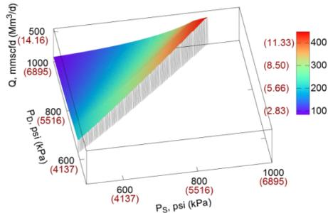
图 5 - 随吸入压力 (PS) 和排出压力 (PD) 变化的压缩机 RC\_fixed\_s\_var\_cl\_min\_power 排气量
