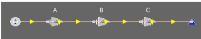
图 25 - 包含 3 个压缩机站的虚拟管道，每个站由 75 英里（121km）、28 英寸（711mm）管道分隔开；所有管道都是 75 英里（121km）长
