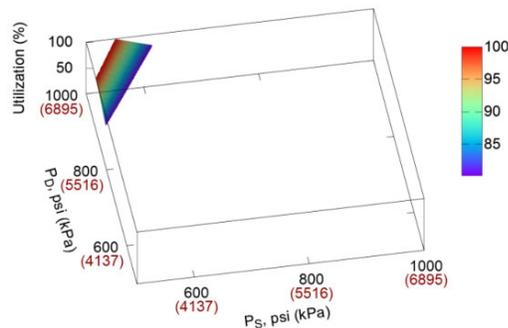
图 11 - 流量为 100 mmcf/d (2.83 Mm<sup>3</sup>/d) 时, 随吸入压力 (PS) 和排出压力 (PD) 变化的压缩机 RC\_fixed\_s\_var\_cl\_min\_power 利用率百分比
