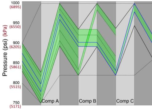
图 32 - 275 mmcf/d (7.79 Mm<sup>3</sup>/d) 流量下，所有压缩机可行性表的图示；蓝线之间的区域表示可行的管道运行区。
