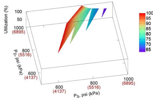
图 3 - 流量为 300 mmcf/d (8.50 Mm<sup>3</sup>/d)、允许连续余隙的情况下，随吸入压力 (PS) 和排出压力 (PD) 变化的利用率百分比
