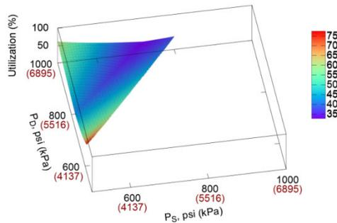
图 2 - 在流量为 100 mmcfd (2.83 Mm<sup>3</sup>/d) 时，随吸入压力 (PS) 和排出压力 (PD) 变化的离心式压缩机利用率百分比，未设置最小功率
