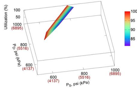
图 8 - 流量为 250 mmcf/d (7.08 Mm<sup>3</sup>/d) 时，随吸入压力 (PS) 和排出压力 (PD) 变化的压缩机 RC\_fixed\_s\_var\_cl\_min\_power 利用率百分比
