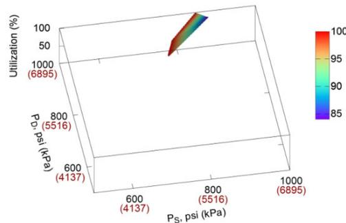
图 6 - 流量为 350 mmcf (9.91 Mm³/d) 时，随吸入压力 (PS) 和排出压力 (PD) 变化的压缩机 RC\_fixed\_s\_var\_cl\_min\_power 利用率百分比
