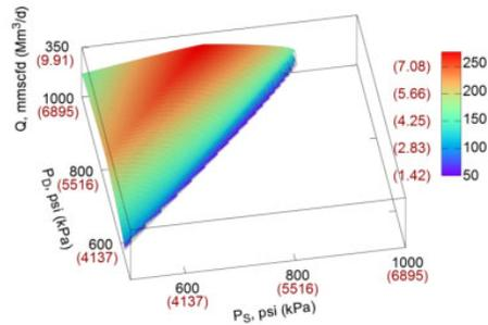
图 14 - 随吸入压力 (PS) 和排出压力 (PD) 变化的离心式压缩机排气量
