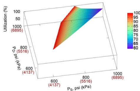
图 4 - 流量为 300 mmcf/d (8.50 Mm<sup>3</sup>/d)、允许连续余隙、允许速度在 250 到 300 rpm 之间变化时，随吸入压力 (PS) 和排出压力 (PD) 变化的利用率百分比
